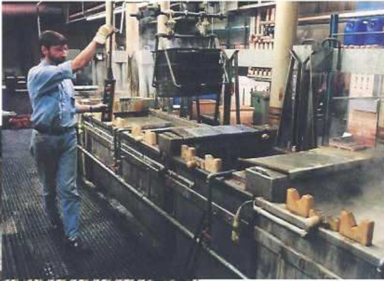
Von der Gewindeprägung bis zur fertigen Dehnstiftschraube: Vor und nach den Arbeitsgängen müssen die Werkstücke immer wieder gewaschen und geölt werden.
